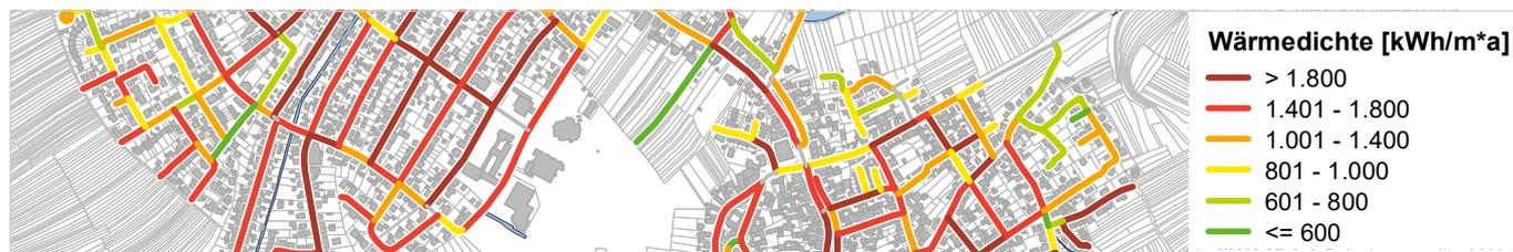
Wie dieser beispielhaften Abbildung zu entnehmen ist, stellt die Wärmedichte den Endenergiebedarf der Gebäude zusammengefasst auf Straßenabschnittsebene dar. Daraus resultiert eine Planungsgrundlage für den Ausbau von Wärmenetzen. Dabei gilt: je höher die Wärmedichte, desto größer sind die Realisierungschancen für Wärmenetze.
