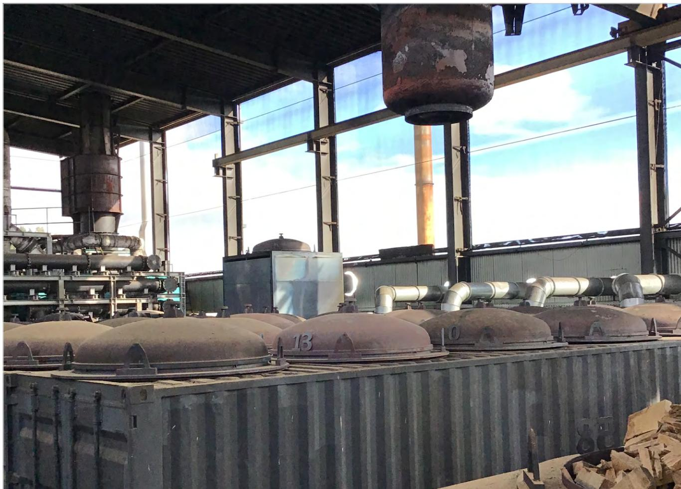
Retorten der Pyrolyseanlage von der Green Carbon GmbH in Üllitz
